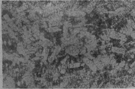
图6 CaF 2 -Al 2 O 3 化学反应(1400°C)产物中的六方钙长石, 圆粒者是 CaF 2 。×100, 普通光
