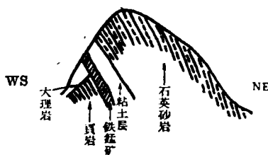
图2 矿床剖面示意图
