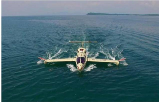
物，能在短时间内将飞行高度拉至 150 米；50cm 的水深可起飞，三重船体设计使得它不会被海水翻转，在 2 米浪高环境自由升降，适应 3 级以上的海况环境，万一引擎故障，也能安全地降落在水面上。据了解，华讯方舟地效翼船目前有 5 人座，8 人座，未来还将推出 20 人座及 30 人座。
