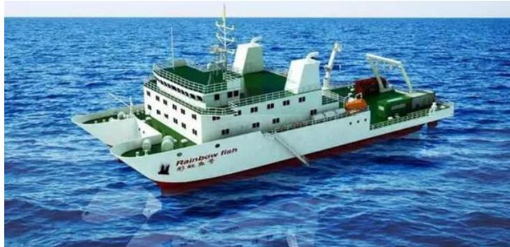
最大吨位小水线面高性能船舶。该船总长 63 米，型宽 23 米，型深 9.4 米，满载排水量约 2200 吨，自持力为 50 天，可载员 60 人。该船集多学科、多功能、多技术手段为一体，可开展深远海调查作业包括海洋声学、物理海洋、地球物理、海洋化学、海底地质科学调查研究以及矿产、生物、基因资源及生物多样性研究；并可满足 4500 米级作业型 ROV、ARV 收放和作业支持的需要。该船还可承担新研发的海洋调查仪器设备的海试平台功能。该船首次采用了国产化大功率直流母排电力推进技术，并首次使用了国产大功率低转速永磁电机，可大大降低震动噪音对水下声学调查的干扰，特别适合于水声调查研究和海洋声学设备的海试。
