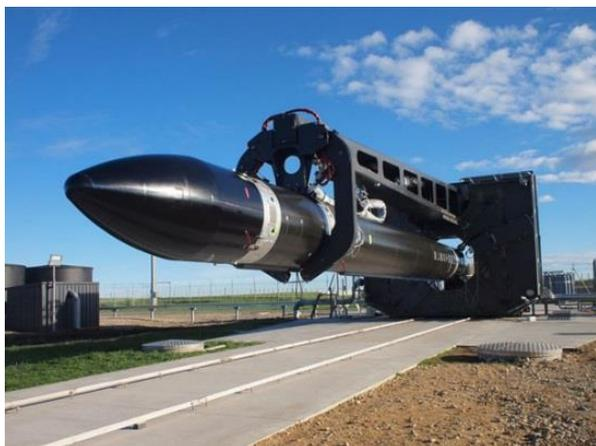
定的轨道。该火箭体长 17 米，发射升空的速度每小时超过 2 万 7000 公里。它的制造成本低、发射周期短、发射费用低廉，堪称人类火箭技术发展史上的一大进步。其搭载的 Rutherford 发动机的主要部件几乎都是 3D 打印制造的。
