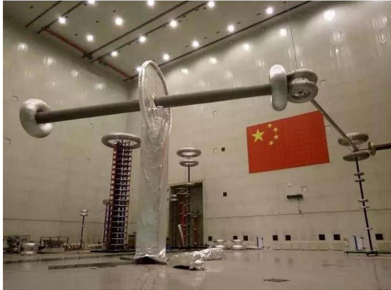
体绝缘穿墙套管核心技术研究及装置研制”课题属于国家高技术研究发展计划(863 计划)项目之一，主要为了解决制约我国±1100 千伏直流输电工程发展中核心装备研制的技术瓶颈，并反哺±800 千伏及以下直流输变电设备的研制，形成具有自主知识产权的产业化生产能力。
