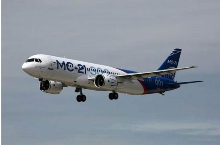
300 两个型号,目前首飞的 300 型号。MC-21-300 能搭载 211 名乘客,最大航程为 3200 海里,比中国的 C919 略大,与空客 A321 相似。而 MC-21-200 机型能搭载 165 名乘客,最大起飞重量为 72560 公斤。MC-21 系列飞机的重心是希望提供比空客 A320neo、波音 737MAX 及中国商飞 C919 更大的运力。MC-21 计划于 2018 年晚些时候交付启动用户俄罗斯航空公司。MC-21 也是首架以高展弦比复合材料机翼为特色的俄商用飞机,复合材料组件包括翼盒和水平及垂直尾翼。
