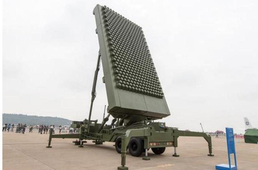
有频选表面天线罩的一种功能升级，保持了对带外干扰的抑制和隐身，同时增加了对带内的防护和目标特性的调制功能。
