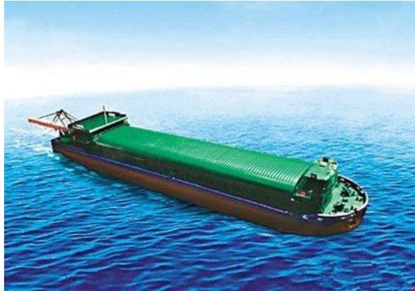
付运。该船总长 70.5 米，型宽 13.9 米，型深 4.5 米，设计吃水 3.4 米，设计载货量 2000 吨。船舶在满载条件下，航速最高可达 12.8 公里/小时，续航力可达 80 公里。全程不消耗燃油，碳、硫等废气污染物及 PM2.5 颗粒等实现零排放；整船电池容量相当于 30-50 台电动汽车电池容量，但整船充电只需要 2 个小时。
