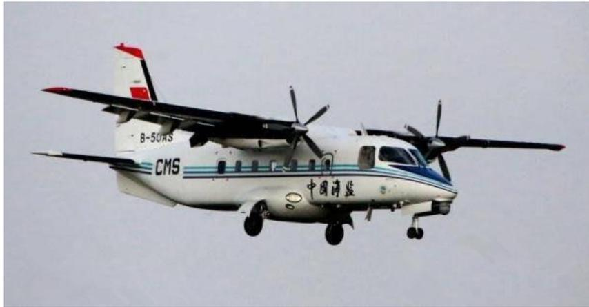
术研发的新一代涡桨通用支线飞机,该机最大起飞重量 8.4 吨,最大商载 3 吨,经济巡航速度 380 公里/小时,具有机身机体容积大、巡航速度快、商载重量比高、航程长、乘坐舒适度高、使用成本低等优势。运 12F 还装有完善的除、防冰系统,并采用低压轮胎,在确保结冰条件下飞行安全性的同时还具备在简易跑道上起降的能力,不仅可以用于中、短程支线客货运输,还可满足航测航拍、海洋监测、遥感、物探、空投空降等长航时通航作业需求。
