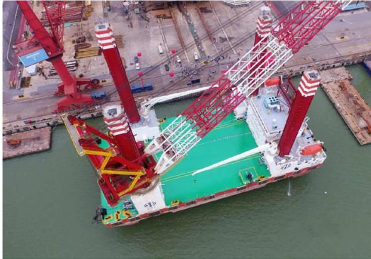
2015年9月18日,黄埔文冲和精钢海工签订1+1座风电安装平台建造合同。2016年3月28日,平台主船体开工。2016年12月15日,平台下水。2017年5月10日,平台完成全程升降试验。该平台创下了黄埔文冲海工产品建造的多个记录:第一次制作八角形桩腿,施工难度大、精度控制要求高,并首次完成总重为400吨的桩腿总段的吊装;一次性顺利完成主吊机满负荷800吨和1.1倍负荷880吨负重试验,这是黄埔文冲目前开展过的最重的一次负重试验;首次安装国内升降载荷量最大的3600吨液压插销式连续升降系统,该系统由精钢海工自主研发,使用寿命更长、工作更为可靠、环境适应性更强,能为单桩提供最大5000吨载荷,确保了平台在大起升重量情况下的稳定性和可靠性。
