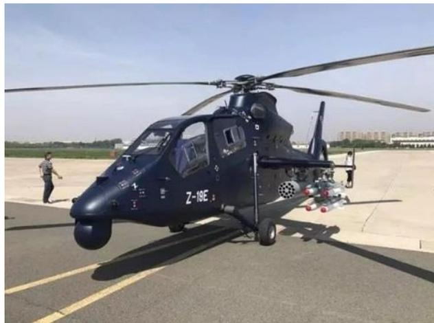
机具有良好的高温、高原性能以及防砂能力，可在全天候、复杂战场环境和野战保障条件下执行各种任务。同时，该机装备的数字式自动飞行控制系统，提高了驾驶的精确性和安全性。完备的生存力体系大幅提高了战场生存能力。界面按照出口要求都做了英文界面，这款直升机完全是按照抗坠毁设计的。抗坠毁座椅上安装了防弹装甲，油箱是抗坠毁至密封的，直升机的起落架就是一个抗坠毁的起落架，它可以吸收大部分的能量，保证机头的完好。据预测，直-19E 在未来 10 年内，市场需求量将达到 100 至 150 架机。
