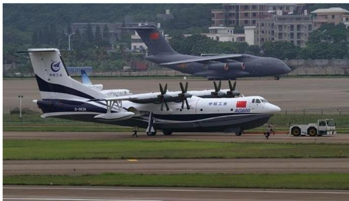
高速滑行等重要测试。AG600 是当今世界上在研的最大一款水陆两栖飞机, 最大起飞重量为 53.5 吨, 最大航程高达 4500 公里。可以执行森林消防、海洋环境监测、资源探测、客货运输等多种任务。
