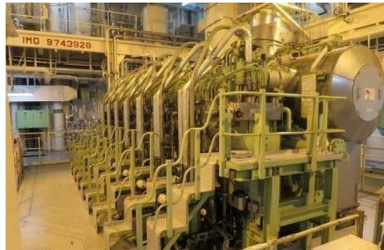
36000 立方米 LEG 船的主推进装置。两艘新船由德国 Hartmann Reederei 公司和挪威 Ocean Yield 公司订造，由太平洋海工建造。目前曼恩公司已手持 8 台 ME-GIE 发动机订单。该机的覆盖功率范围为 5-90MW。该型机还能使用 LPG 和甲烷或者乙烷混合燃料，气体模式效率不变，LPG 的比例可达 50%甚至更高。ME-GIE 机还可使用几乎所有形式的废气作为燃料，为该型机的新应用打开了大门，包括 FPSO。
