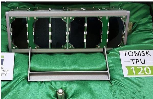
态，从而判定是否可以继续利用这些材料制造航天器。“托木斯克-TPU120”长 30 厘米，宽 11 厘米，高 11 厘米，与传统的纳米卫星不同之处在于，其星体是用 3D 打印技术完成的。
