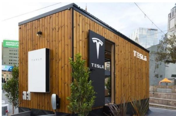
这种以太阳能为中心的演示拖车可以完全通过太阳能作为日常生活的能源，而这其中就使用了特斯拉的太阳能电池板和 Powerwall 能量存储装置。这幢太阳能小屋的墙壁由纯木材打造，并没有经过人工化学处理。它的总重量为 2 吨，在屋顶使用了 6 个太阳能电池板，拥有 2kW 的太阳能发电能力，可以满足安装在墙体侧面 Powerwall 太阳能电池的存储需求。
