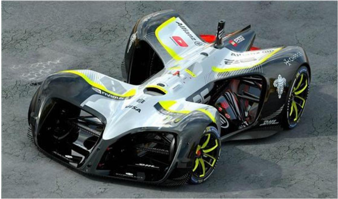
Robocar 车重 975 公斤，长 4.8 米，宽两米，搭载有四台电动机。每一台的功率为 300 千瓦，该车还安装有一个 540 千瓦的电池组，时速可达 320 公里。
