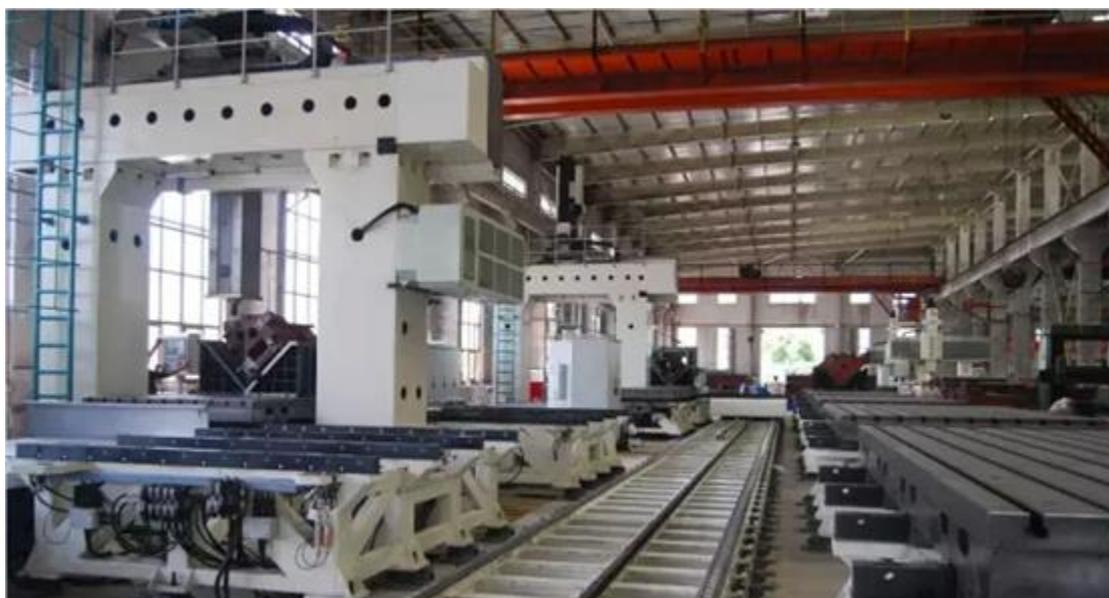
该项目建设期3年，总投资3.5亿元，项目资金实际到位33568.49万元，到位率95.52%。项目由生产线内加工和生产线外加工两部分组成，生产线内加工主要承担零件的精加工，生产线外加工主要承担零件的部分半精加工及上线前工艺验证。项目研制内容包括数字化车间管控系统、智能机床研究及智能加工技术、五条(床身、床头箱、主轴、床鞍、三座/尾座)机床关键零件柔性生产线及与之配套的线外设备、智能升级改造设备、在线测量系统、刀具管理系统，共投入91台/套设备组成。实现混流柔性制造、自动上下料、产品自动识别和跟踪、在线自动检测、产品流向智能控制、智能故障诊断、加工参数优化、生产过程实时监控和生产管理信息化。
