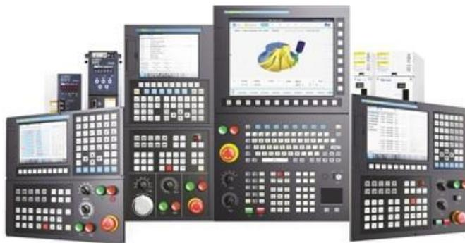
HNC-848 数控装置品是全数字总线式高档数控装置，瞄准国外高档数控系统，采用双 CPU 模块的上下位机结构，模块化、开放式体系结构，基于具有自主知识产权的 NCUC 工业现场总线技术。具有多通道控制技术、五轴加工、高速高精度、车铣复合、同步控制等高档数控系统的功能，采用 15 液晶显示屏。主要应用于高速、高精、多轴、多通道的立式、卧式加工中心，车铣复合，5 轴龙门机床等。
