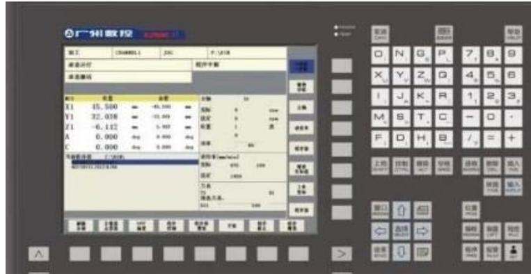
广州数控拥有车床数控系统、钻、铣床数控系统、加工中心数控系统、磨床数控系统等多领域的数控系统。其中，GSK27 系统采用多处理器实现 nm 级控制；人性化人机交互界面，菜单可配置，根据人体工程学设计，更符合操作人员的加工习惯；采用开放式软件平台，可以轻松与第三方软件连接；高性能硬件支持最大 8 通道，64 轴控制。
