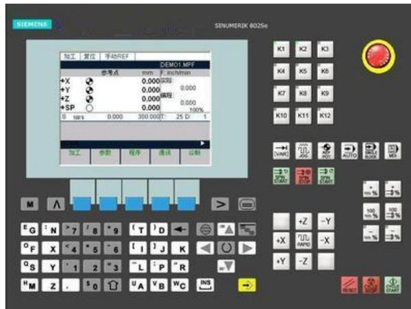
SIEMENS 公司的数控装置采用模块化结构设计，经济性好，在一种标准硬件上，配置多种软件，使它具有多种工艺类型，满足各种机床的需要，并成为系列产品。随着微电子技术的发展，越来越多地采用大规模集成电路(LSI)，表面安装器件(SMC)及应用先进加工工艺，所以新的系统结构更为紧凑，性能更强，价格更低。采用 SIMATIC S 系列可编程控制器或集成式可编程控制器，用 SYEP 编程语言，具有丰富的人机对话功能，具有多种语言的显示。
