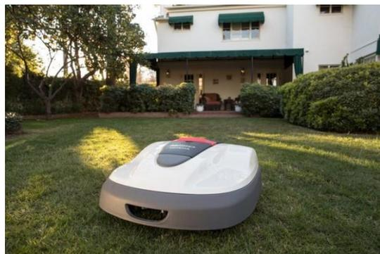
据了解，HRM 310 型号配备 22.2v-1.8Ah 电池组，每次充点电可以维持大概半小时的工作。HRM 520 型号则配备更大的 22.2v-3.6Ah 电池，每次充完电可以使机器人工作达 60 分钟。
