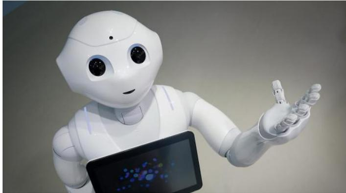
融合技术至关重要。比如日本 Pepper 机器人就配有 1 个 3D 传感器、5 个触摸传感器、2 个陀螺仪、2 个声波定位仪、3 个缓冲传感器、6 个激光传感器。通过这项技术，Pepper 能识别人的表情、语气、周围环境，并根据人的情绪做出更丰富的、更人性化的反应。
