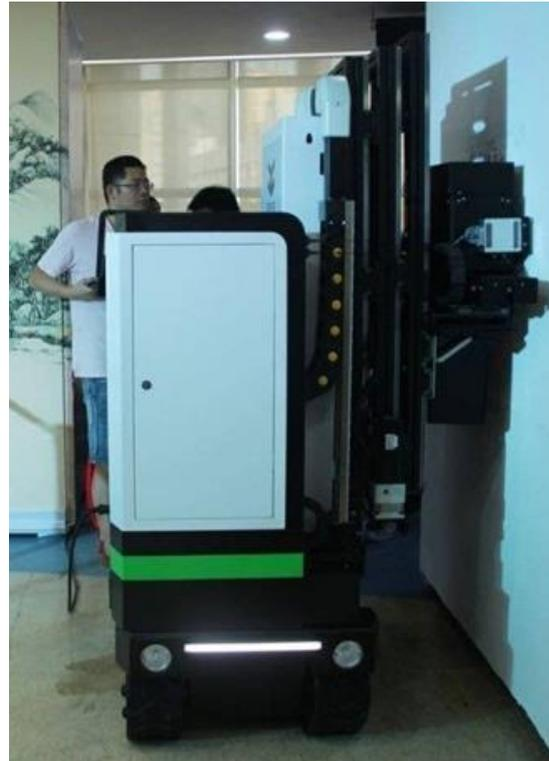
据介绍，该机器人拥有多项科研成果，已成功申报 6 项国家发明专利，还有 20 多项发明专利在等待相关部门审核。这款机器人技术上突破 16 轴控制系统、CAM 软件输出 16 轴 G 代码、0.05 毫米高精度室内坐标定位、重量不超过楼板负荷、在不平整墙面施工、喷墨打印侧喷技术、3D 打印供料系统、无人状态下施工、便捷进入施工现场、系统操作简单易上手等十大难点。
