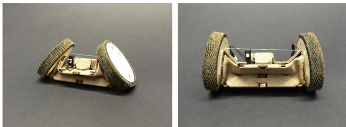
NASA 透露，该系列机器人的设计灵感来源于折纸，它们将被用来探索极端的外星环境。此系列机器人名为 Puffer，可折叠的特殊设计使得它们能轻易“搭顺风车”，比如装进一台火星探测车或者木卫二着陆器里。
