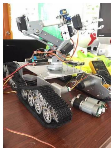
这台有点像辆缩微版小坦克的是标点机器人，智慧农场里的 300 亩桃树都是它挖坑栽种的。这个机器人平均每分钟可以挖 20 个种果树的标准坑，是人力速度的五到六倍。
