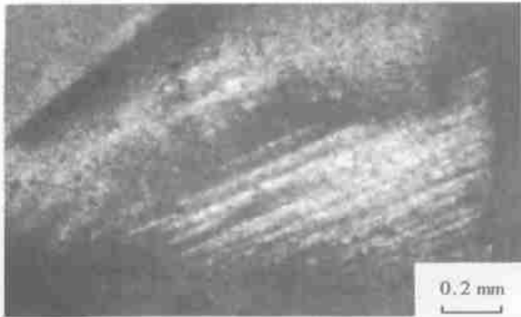
图 7 PMNT76/24 晶体极化后电畴条带变宽变直(极化样, 正交偏光下, (001)晶片)
