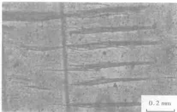
图 5 PMNT67/33 晶体退火后电畴条带显著加宽(退火样, 正交偏光下)
