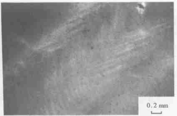
图 8 已极化 PMNT67/33 晶体 (001) 晶片的电畴(极化样, 正交偏光下)
