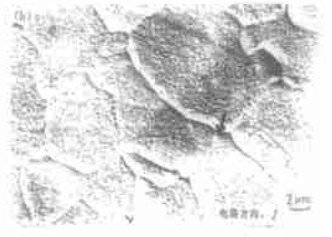
b) 温度 > T_c 空间电荷区及残留电畴 (箭头处)
