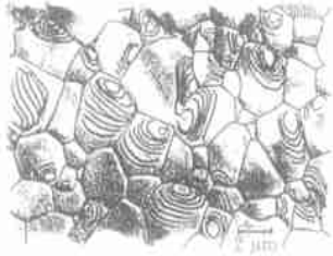
图 5 铌酸盐压电瓷 (TEM)
