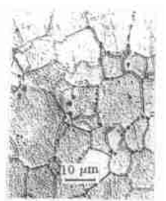
图 18 PLZT 陶瓷热腐蚀后, 三晶界交点处的沉积物 (反光) [4]
