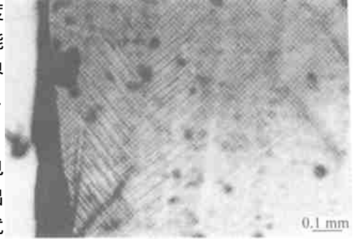
图 4 PMNT67/33 单晶在单畴化程度不高时, 于晶片边缘残存的 71^\circ (或 109^\circ ) 电畴结构透射光显微镜下观察
