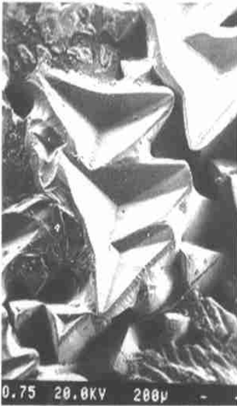
图 2 SEM 下观察到的 PMNT 晶体顶部的表面形貌
