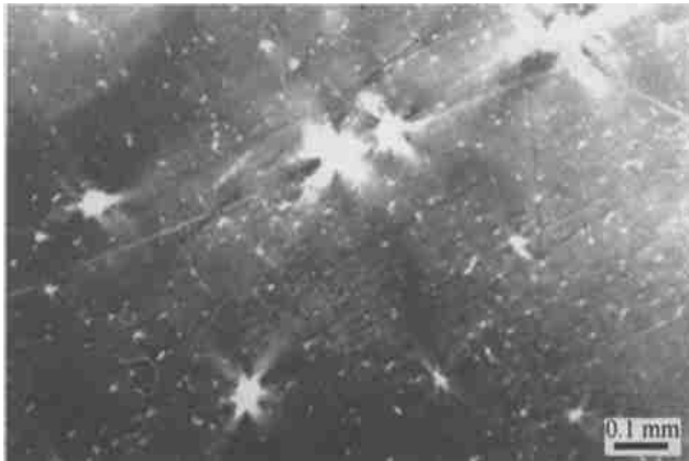
图 6 正交偏光下观察的 PMNT 晶体中的散射颗粒
