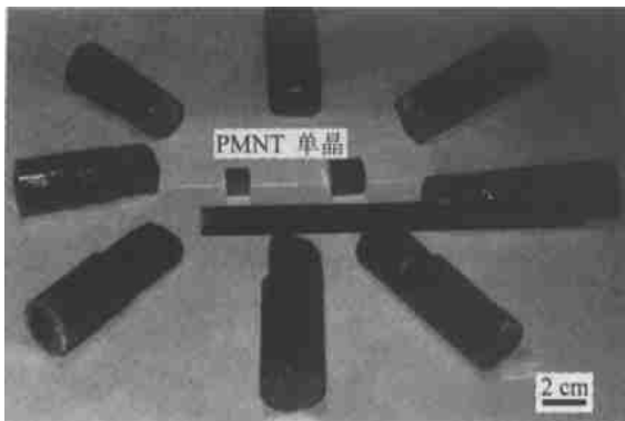
图 1 用改进的 Bridgman 法生长的 PMNT 晶体毛坯
